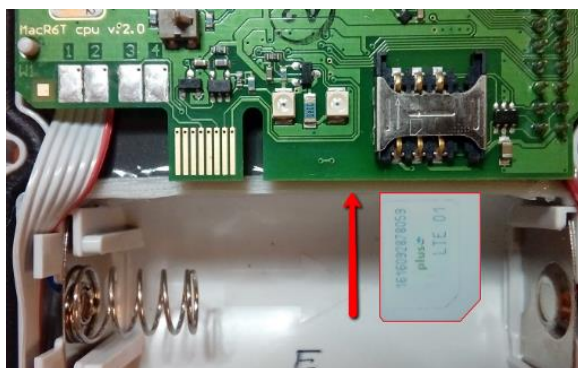
Montaż karty SIM w urządzeniu MacR6-Z0-P
