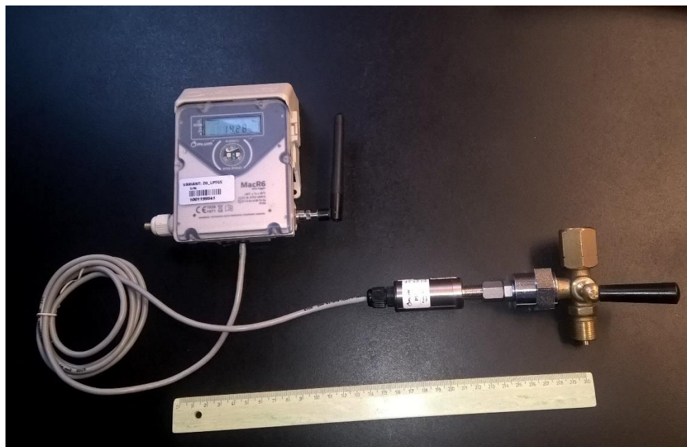
Przykład podłączenia rejestratora z zaworem manometrycznym, trójdrożnym.
